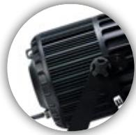
Unser neu entwickeltes Gehäuse des BabyZoom4 erlaubt uns einen lüfterlosen Betrieb. Das Thermo Design mit Heatpipes hat viele Vorteile, wie zum Beispiel die gleichmäßige Wärmeableitung über den gesamten Kühlkörper. Das optimierte Kühlrippen Design sorgt nicht nur für einen gleichmäßigen Luftstrom, sondern ermöglicht uns auch diese kompakte Bauweise.
