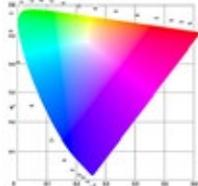
Im Helios+ 19Z ist die bewährte und leistungsstarke 15W OSRAM® Ostar RGBW LED verbaut. Die Primärfarben (rot @ 632nm, grün @ 520nm und blau @ 453nm) ermöglichen ein breitgefächertes Farbspektrum. Alle Geräte sind kalibriert, um die gleiche Lichtleistung zu gewährleisten.
