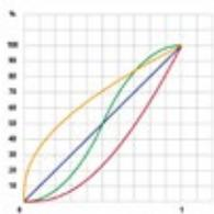
Der Helios+ 19Z verfügt über vier Dimmkurven, eine lineare und drei nicht-lineare, um dem Nutzer das gewünschte Dimmverhalten zu ermöglichen. Alle vier Dimmkurven werden hierbei von der neuen, einzigartigen SteadyColor™ Dimming Technologie unterstützt und sind äußerst weich und präzise.
